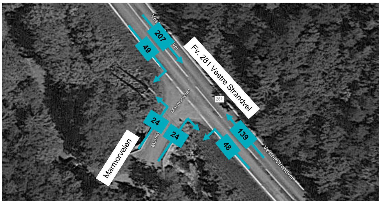
Figur 15: Makstimetrafikk (ettermiddag) med retningsfordeling i krysset Marmorveien x fv. 281 (2045). Trafikkmengdene og retningsfordelingen er estimert ved bruk av ulike datakilder og metoder. (Bilde: Google Maps)
