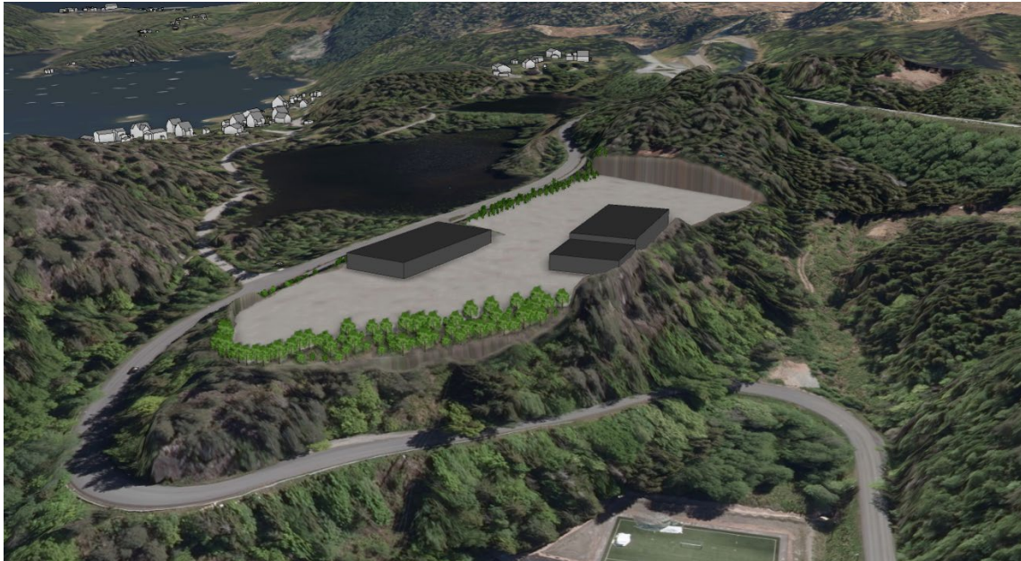
Figur 211: 3D modell som viser tiltaket med revegetert skråning og voll. Eksisterende vegetasjon er ikke vist i denne 3d-modellen.
